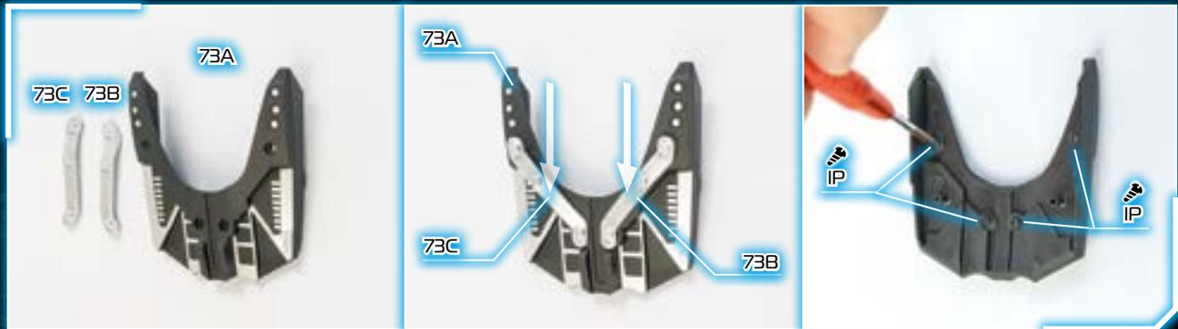
1 - Начните с установки элементов 73B (левый) и 73C (правый) на нагрудную пластину (73A). Разместите их так, как показано на фотографии, после чего каждый из них закрепите с обратной стороны двумя винтами IP.
